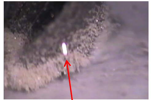
砥粒が電界により刃先に集中
