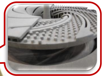
鋳型の軽量化・ガス抜き構造の検討例
